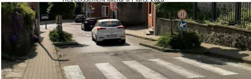
Rétrécissement double (écluse) © Pluris, 2023
